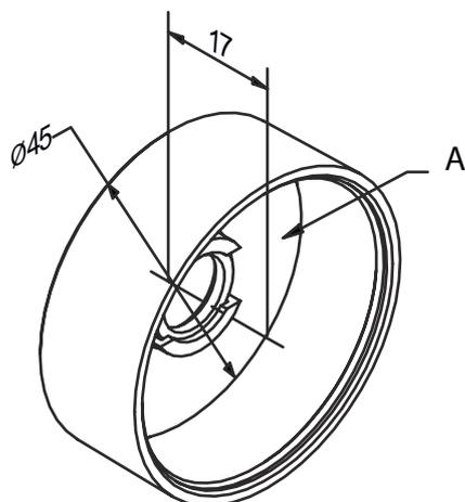
REMARQUE Cache pour un réglage simple du foyer et pour le changement d'objectif. Retirer après usage et remettre le capuchon d'origine en place.
