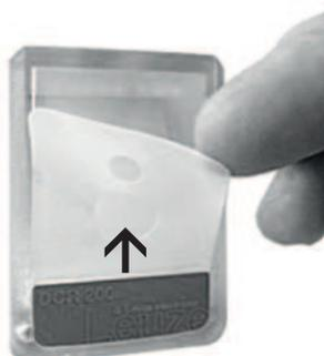
Figura 6.9: Applicazione del film diffusore
