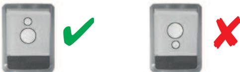
Fig. 6.8: Orientation du film diffuseur
