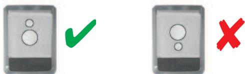
Figura 6.8: Orientación de la lámina difusora
