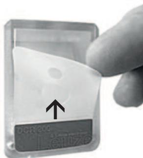
Figura 6.9: Colocar una lámina difusora
