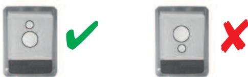
Bild 6.8: Orientierung der Diffusorfolie
