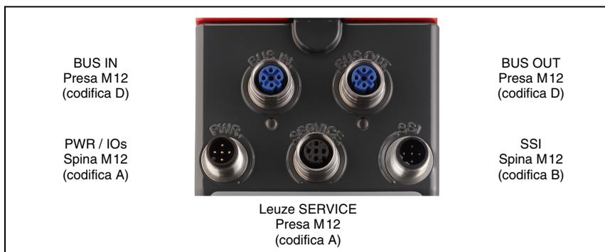
Figura 7.1: Collegamento del AMS 348i SSI
