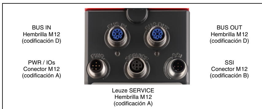
Figura 7.1: Conexiones del AMS 348i SSI
