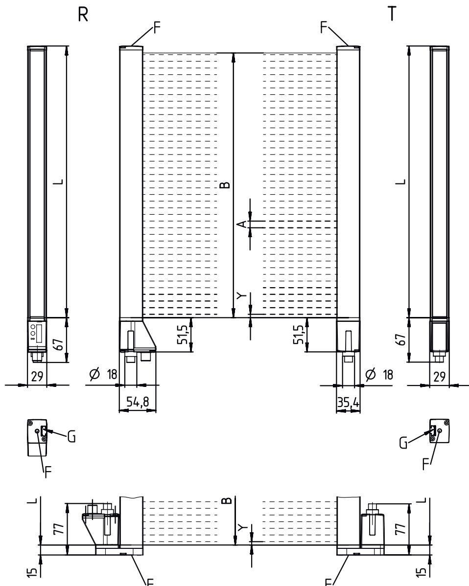
A Intervalle entre les faisceaux 10 mm
