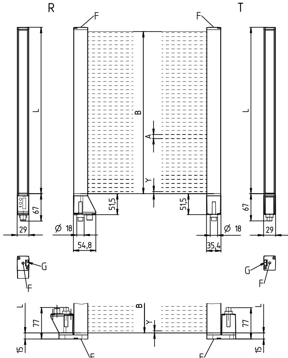
A Intervalle entre les faisceaux 40 mm
