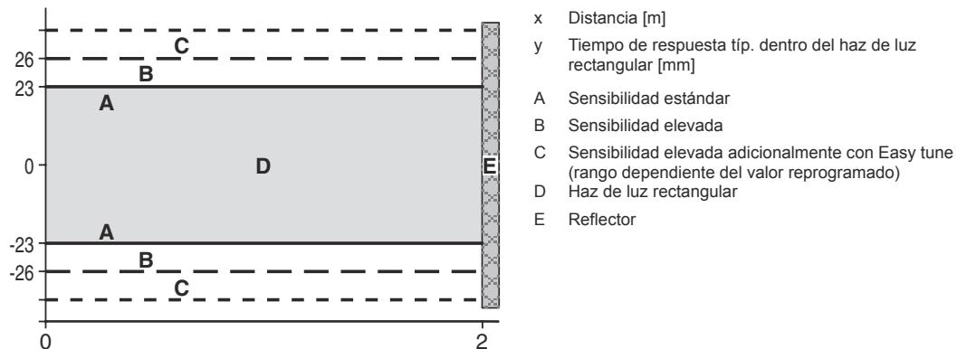
Objeto de referencia para la detección: 12 mm con reflector TKS 40x60
