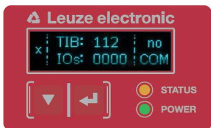
Bild 3.6: Funktionstasten am Empfänger
