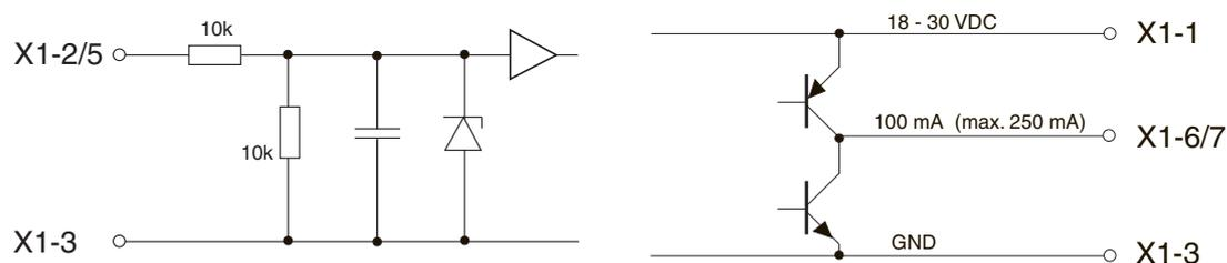
Figura 7.4: Rappresentazione del principio di ingressi/uscite digitali
