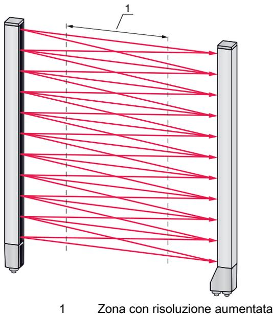
Figura 4.3: Percorso del raggio nel modo oper. raggi «Incrociato»
