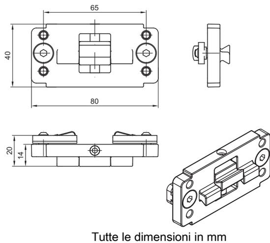
Figura 15.7: Supporto di serraggio BT-2P40
