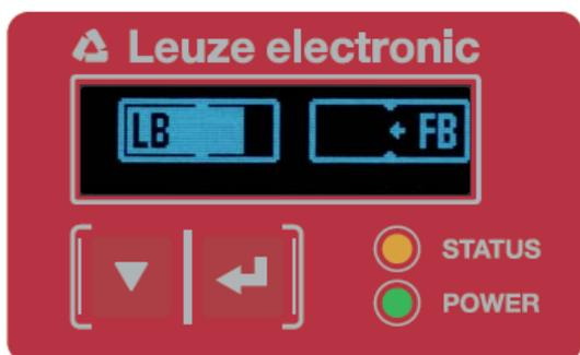
Figura 8.1: Esempio: rappresentazione display di una barriera fotoelettrica non correttamente allineata
