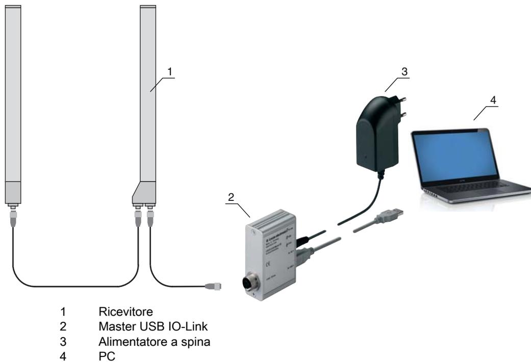
Figura 11.2: Collegamento CSL 710 al master USB IO-Link
