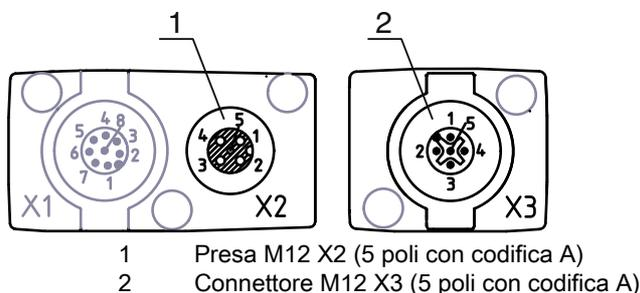
Figura 7.7: Collegamento X2/X3 – CSL 710
