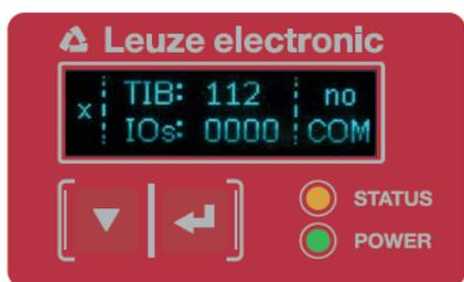
Figura 3.6: Tasti funzione sul ricevitore
