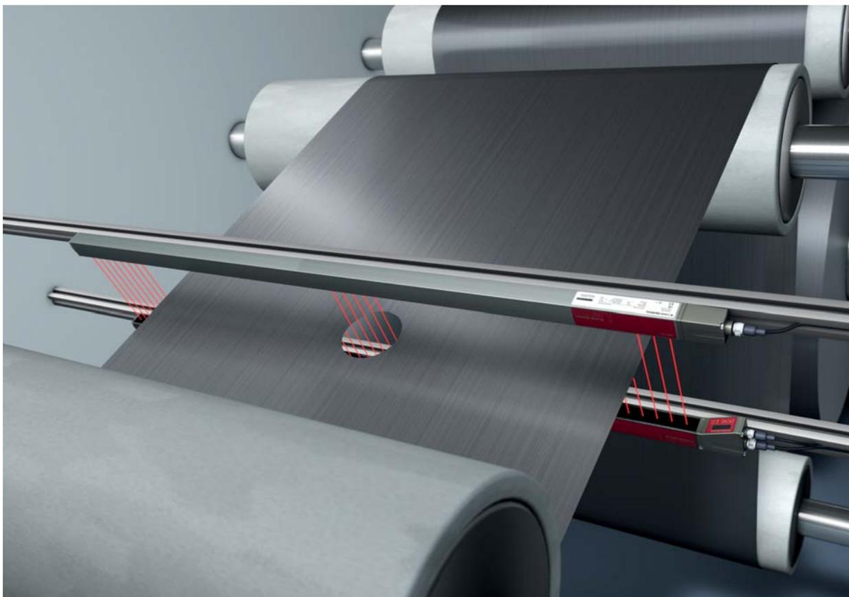
Figura 5.3: Riconoscimento fori
