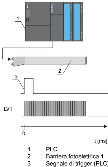
Figura 4.8: Comando via trigger esterno
