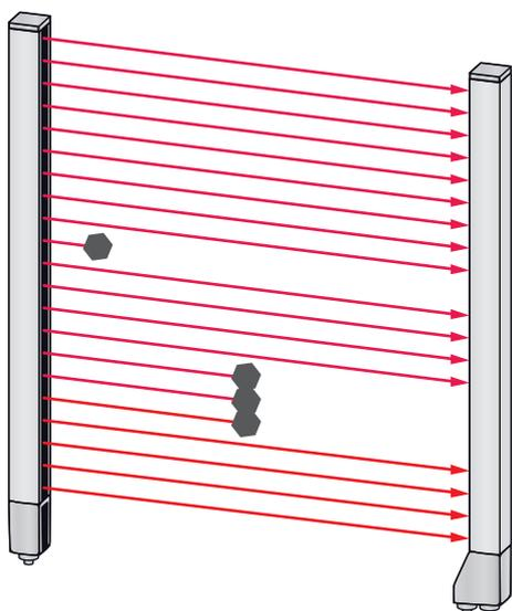
Figura 4.7: Configurazione smoothing «3» e tre o più raggi adiacenti interrotti – l'apparecchio commuta
