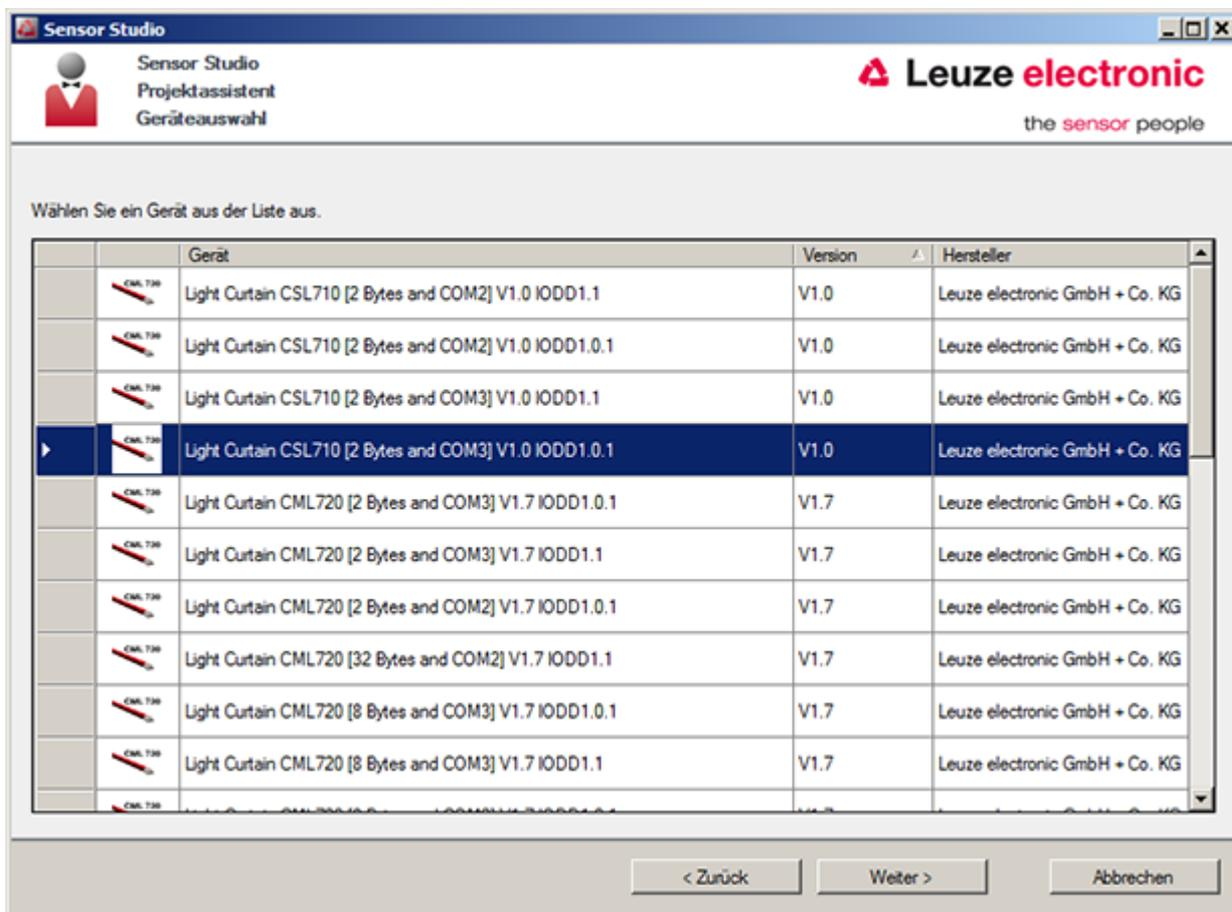
Figura 11.3: Selezione dell'apparecchio per barriera fotoelettrica di intercettazione CSL 710i
