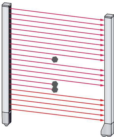
Figura 4.6: Configurazione smoothing «3», ma al massimo solo due raggi adiacenti interrotti – l'apparecchio non commuta
