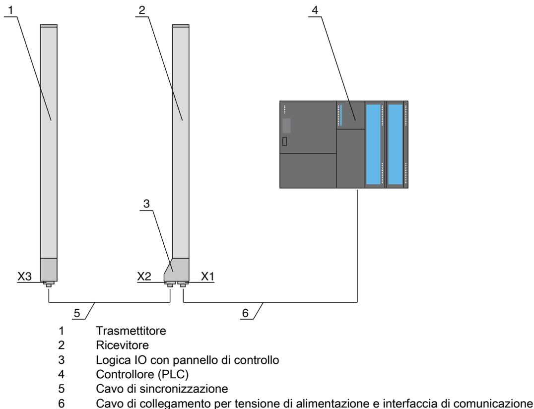
Figura 3.1: Intero sistema in interazione con un PLC
