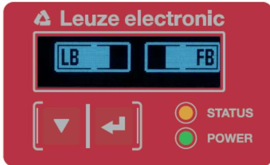
Figura 8.7: Representación del display después de un Teach realizado con éxito
