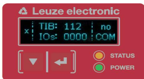
Figura 3.3: Display OLED en el receptor
