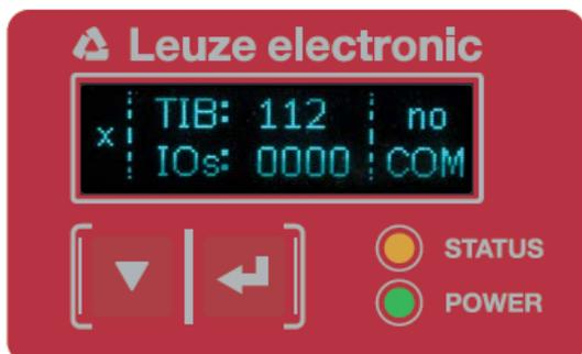
Figura 8.3: Indicación en el display del estado del modo de proceso de la cortina óptica
