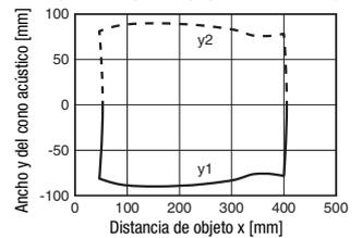
Comportamiento de respuesta típ. (barra  $\varnothing 25\text{mm}$ )
