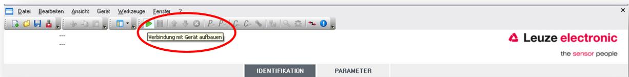
Nun können Sie die OFFLINE-Ansicht starten und die Konfiguration an das Gerät übertragen. Klicken Sie hierzu in der Symbolleiste zuerst auf die Schaltfläche **Offline-Parameter...**
