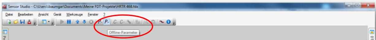
Um die Daten des angeschlossenen Gerätes bearbeiten zu können, müssen Sie diese zuerst aus dem Gerät auslesen. Klicken Sie hierzu in der Symbolleiste auf die Schaltfläche **Parameter vom Gerät hochladen**:
