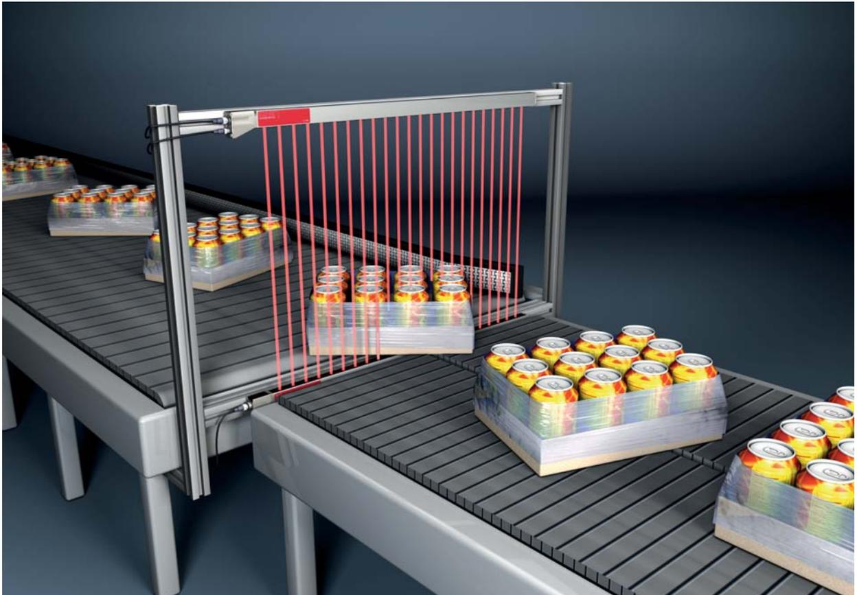
Bild 5.3: Breitenmessung, Lageerkennung
