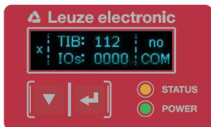
Bild 3.6: Funktionstasten am Empfänger
