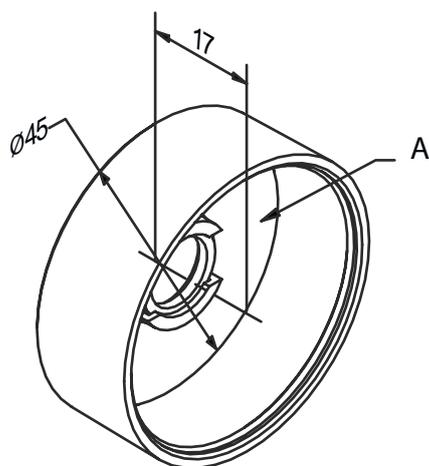
AVVISO Cappa di copertura per facilitare la messa a fuoco e la sostituzione della lente. Rimuovere dopo l'utilizzo e rimontare la calotta originale.
