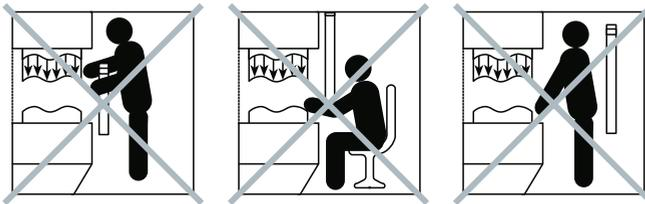
**Abb. 1** Übergreifen, Untergreifen und Hintertreten müssen ausgeschlossen sein
