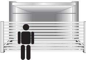
**ECO Lichtvorhänge in kaskadierter Ausführung für den Handschutz und Hintertretschutz an Gefahrstellen**
