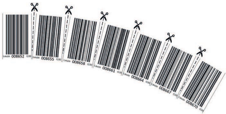
图 9.10: 垂直曲线内的条码带加工
