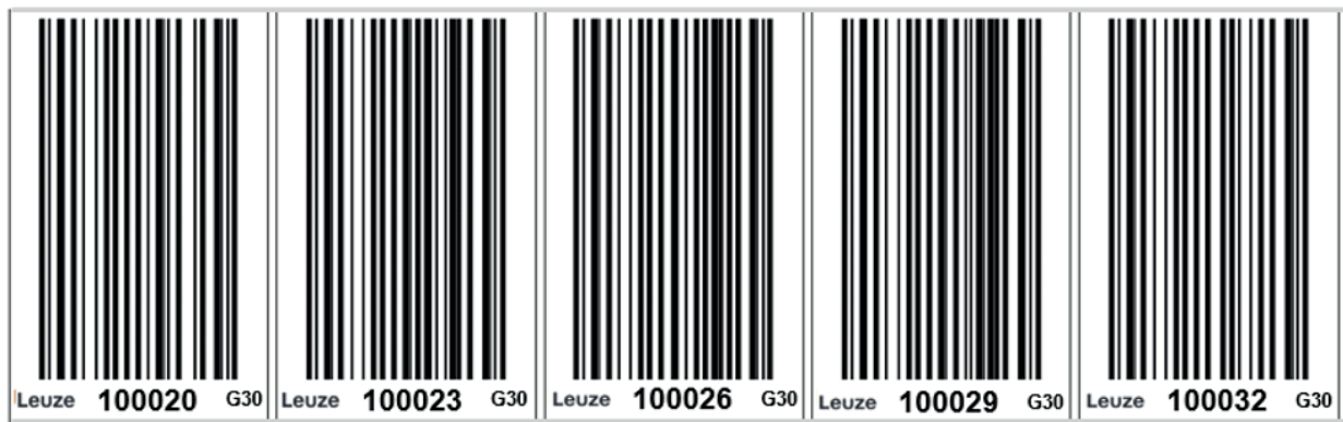
图 3.2: 条码带，从位置值 1000.20 m 开始并以 3 cm 增加 条码无中断排列，形成呈 30 mm 栅格的数字化测量尺带。BCB 沿测量路线（行驶路线）粘贴。
