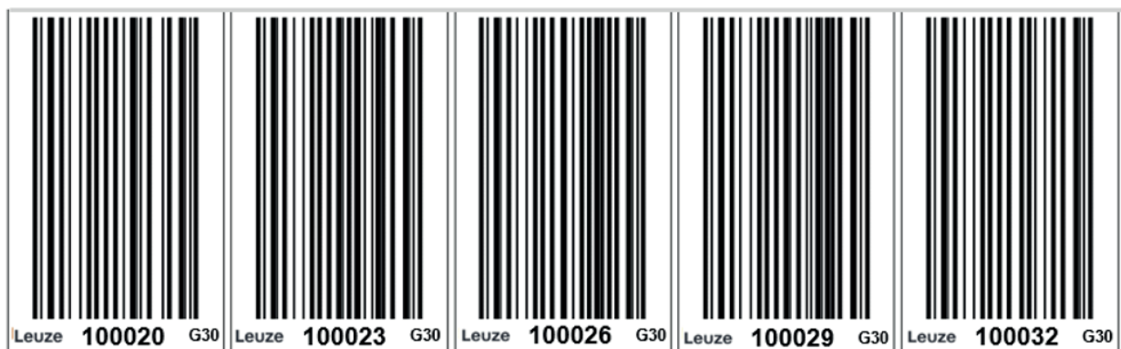
Fig. 3.2: Fita de códigos de barras, começando com o valor de posição 1000,20 m e aumentando em 3 cm. Alinhados um após o outro, sem interrupções, os códigos de barras formam uma fita métrica digitalizada com grade de 30 mm. A fita de códigos de barras é colada ao longo do trajeto de medição (trajeto).
