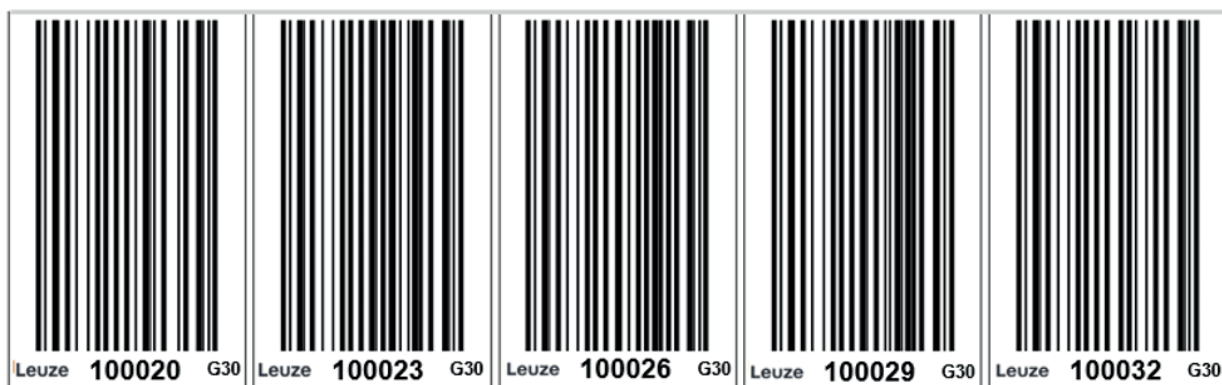
Figura 3.2: Nastro a codici a barre che comincia con il valore di posizione 1000,20 m, con incrementi di 3 cm
