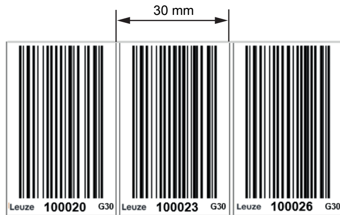
Fig. 9.12: Exemple: vérifier les 30 mm sur l'impression de la bande à codes à barres de réparation en ligne
