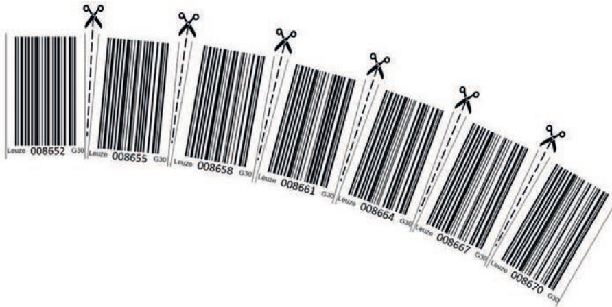
Figura 9.10: Procesamiento de la cinta de códigos de barras en curvas verticales
