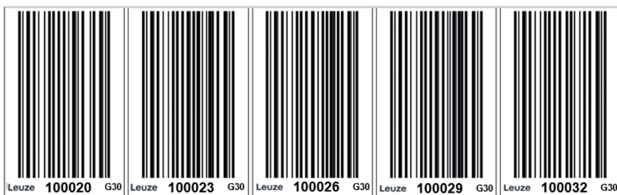
Figura 3.2: Cinta de códigos de barras, que comienza con un valor de posición de 1000,20 m, durante el avance va subiendo en 3 cm
