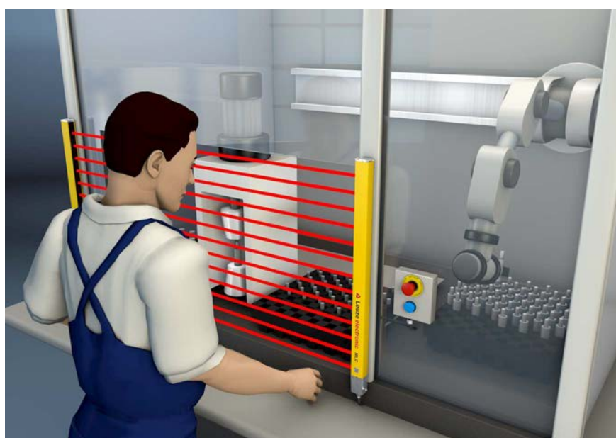
Fig. 5.2: Resgare as proteções de acesso a pontos de perigo ao intervir na zona de perigo, por exemplo, no caso de uma aplicação de robô pick & place
