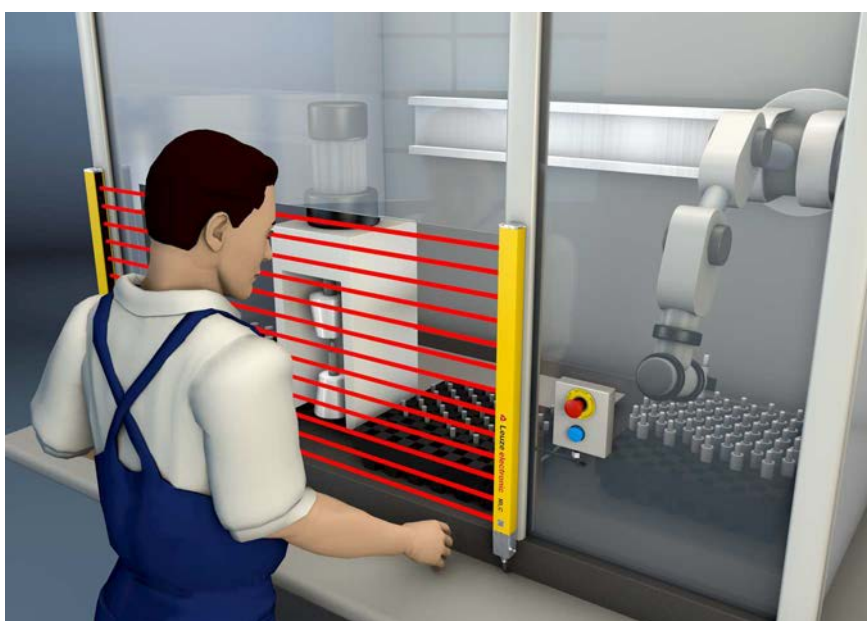
Fig. 5.2: Resgarde as proteções de acesso a pontos de perigo ao intervir na zona de perigo, por exemplo, no caso de uma aplicação de robô pick & place
