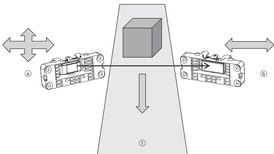
a Alignement vertical et horizontal du capteur
