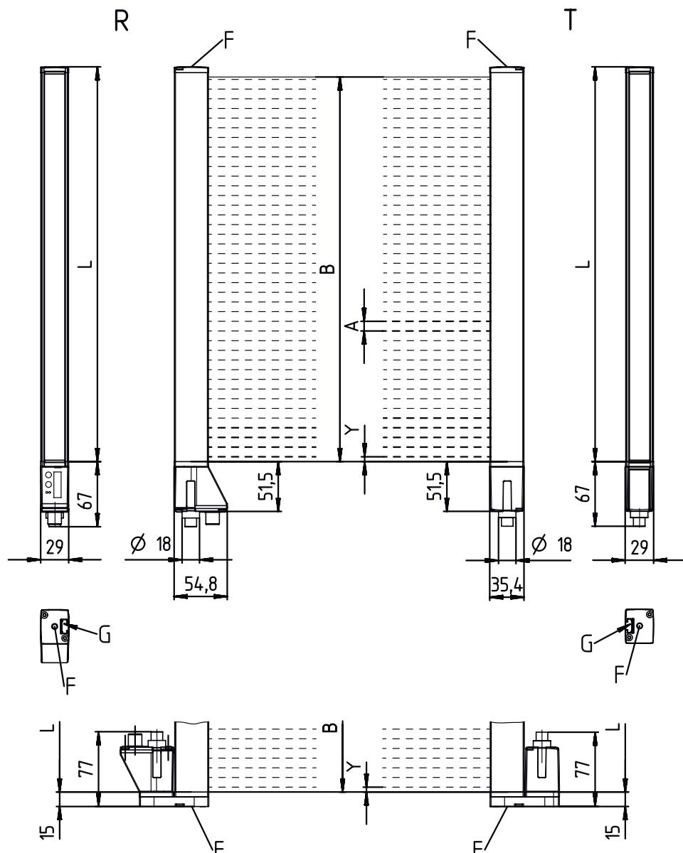
A Intervalle entre les faisceaux 20 mm
