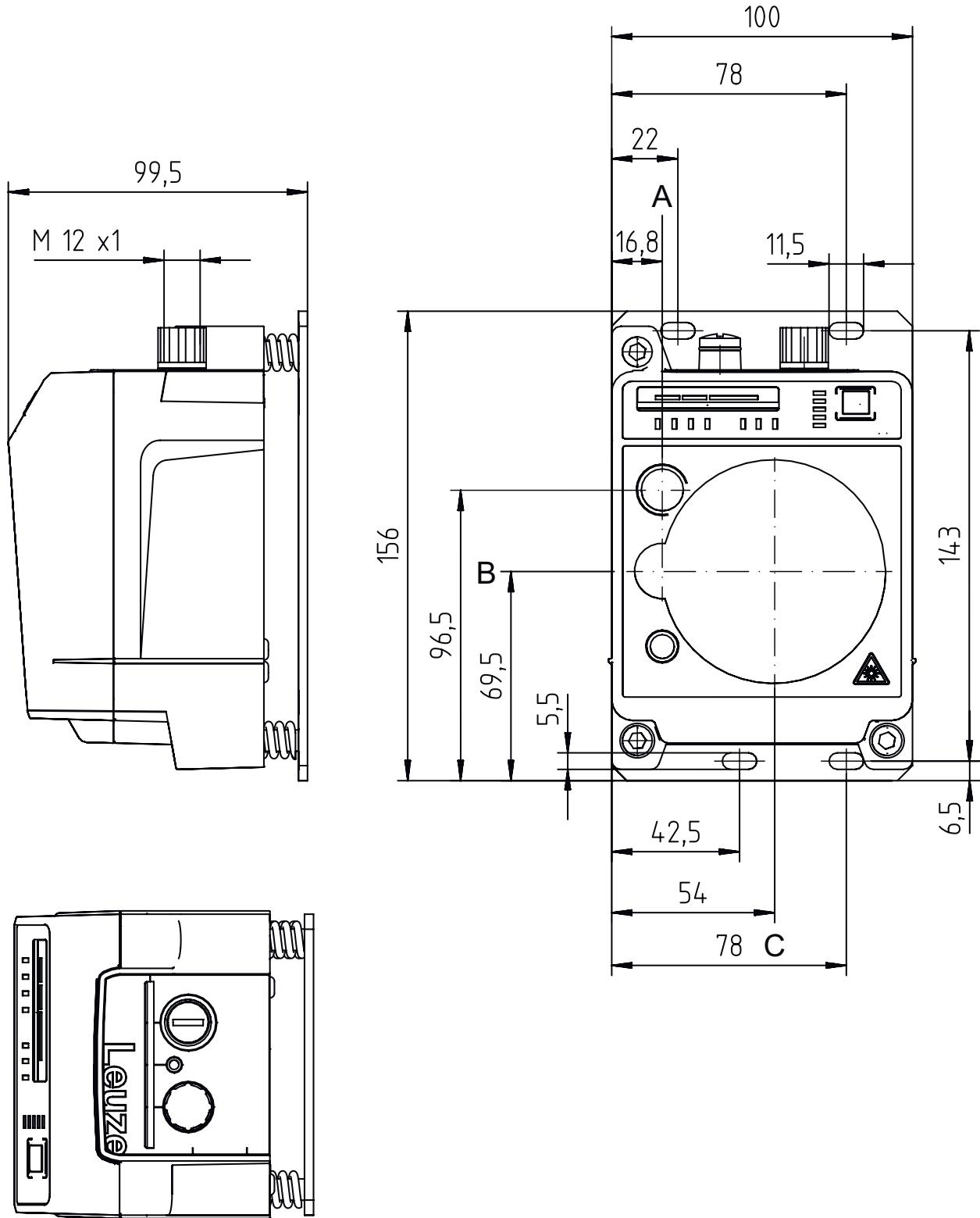
A Mittelachse Sender und Ausrichtlaser
