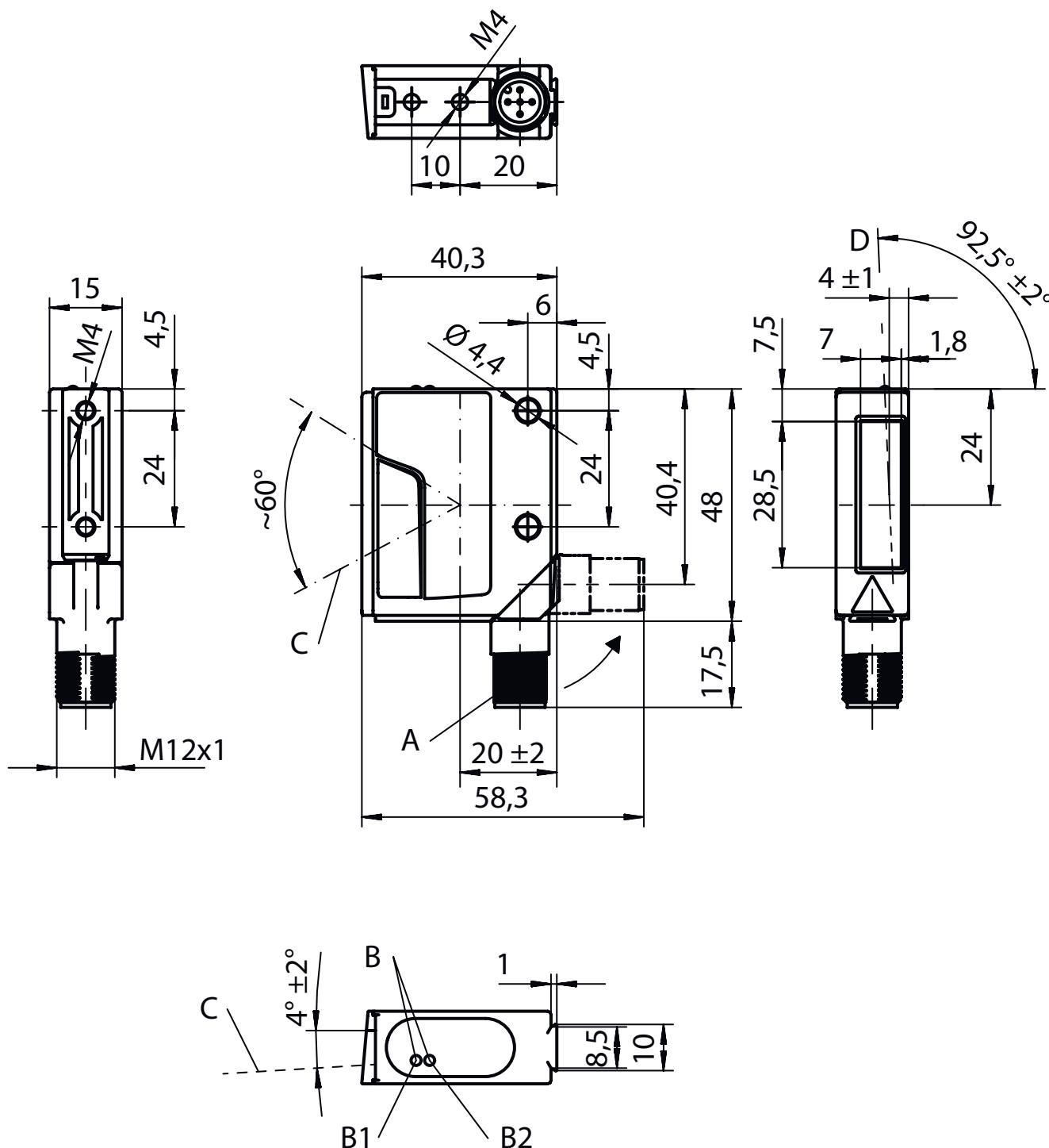
A Drehstecker, um 90° drehbar
