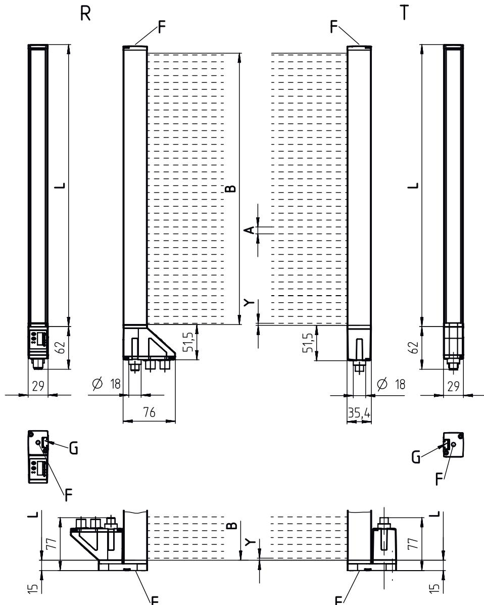
A Intervalle entre les faisceaux 5 mm
