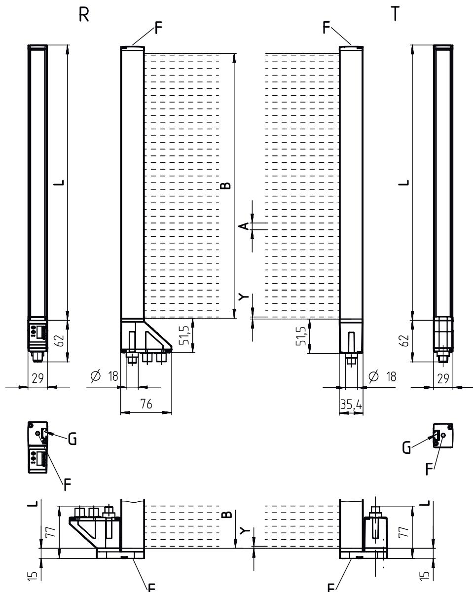
A Intervalle entre les faisceaux 5 mm
