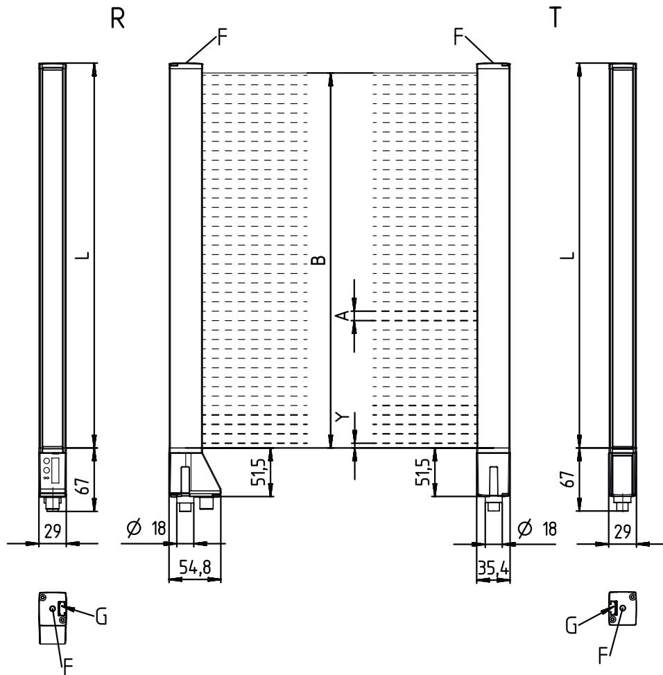
A Intervalle entre les faisceaux 5 mm
