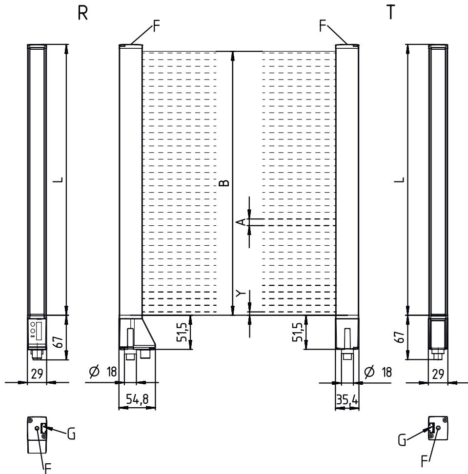
A Intervalle entre les faisceaux 40 mm
