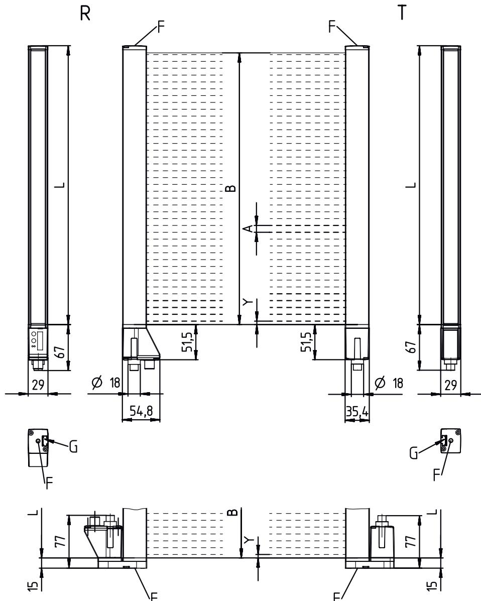
A Intervalle entre les faisceaux 5 mm
