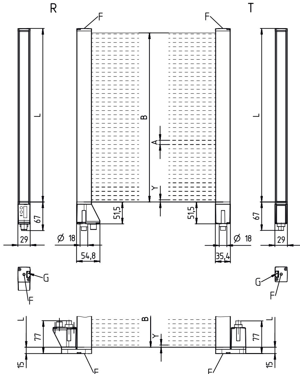
A Intervalle entre les faisceaux 5 mm
