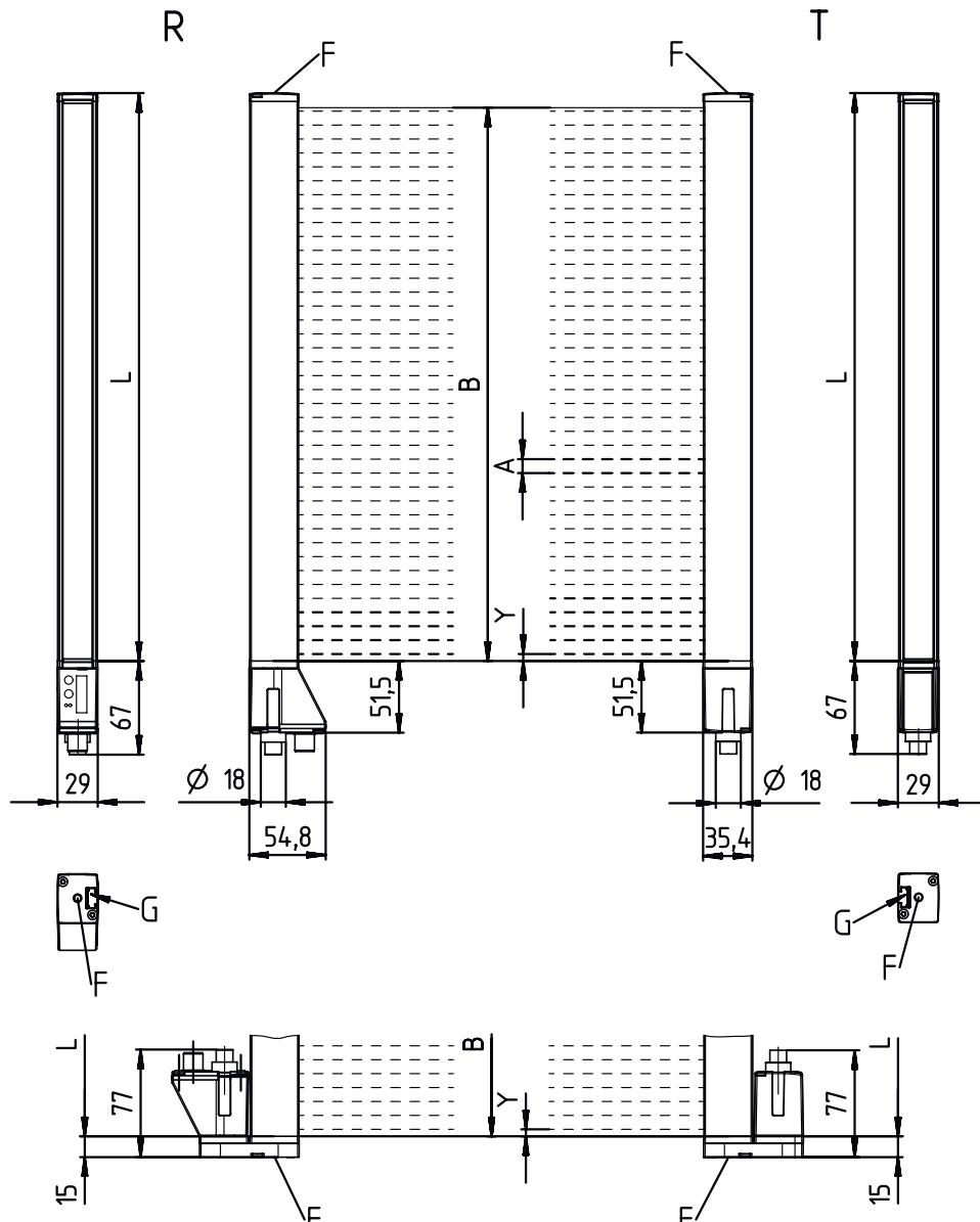
A Intervalle entre les faisceaux 5 mm
