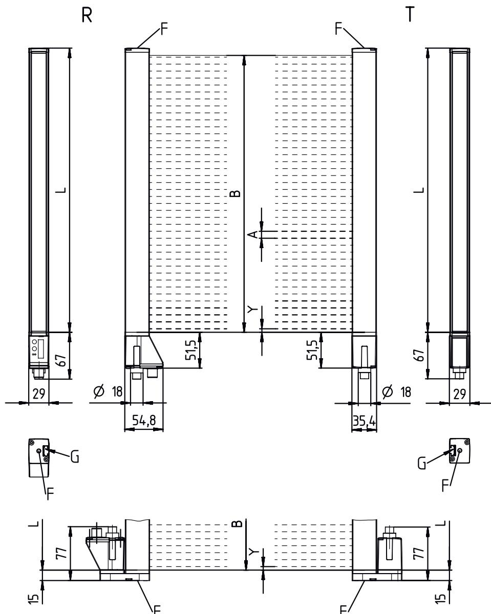
A Intervalle entre les faisceaux 20 mm
