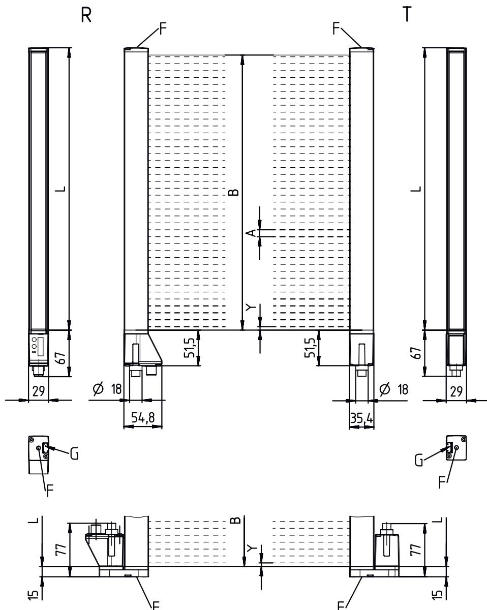
A Intervalle entre les faisceaux 10 mm
