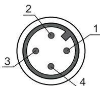
Figura 5.1: Assegnazione dei pin del trasmettitore
