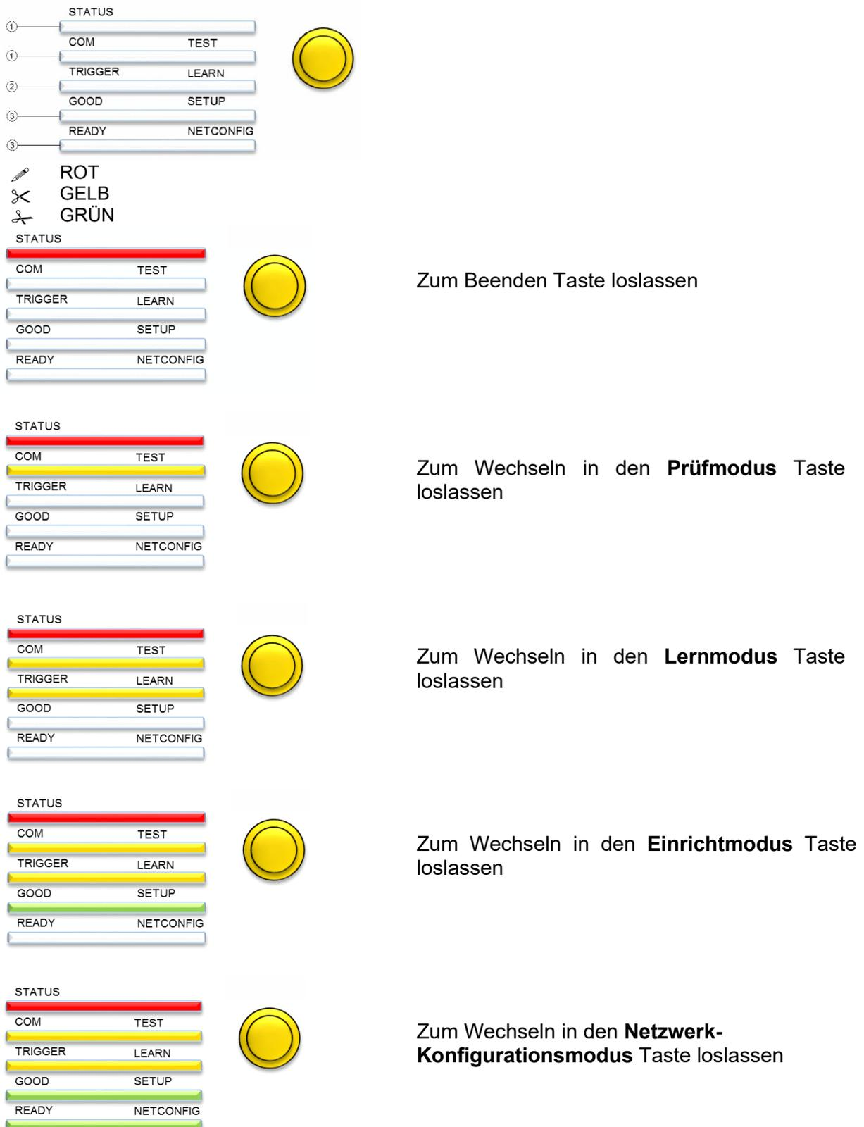
Abbildung 34: HMI-LEDs für die Betriebsarten
