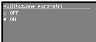
Il LED PWR si accende in arancione, il display viene mostrato invertito. Ora si possono impostare singoli parametri sul display.
