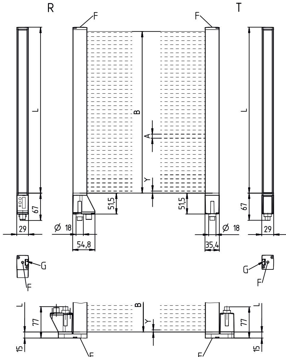
A Intervalle entre les faisceaux 10 mm
