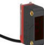
50145234 | LE5B/4       | 0 ... 12,5 m<br>0 ... 17,5 m          | Tensión de alimentación: CC<br>Salidas digitales: 1 Unidad(es)<br>Salida 1: Transistor, PNP, De conmutación claridad<br>(de conmutación oscuridad por inversión de polaridad de UB)<br>Frecuencia de conmutación: 900 Hz<br>Conexión: Cable, 2.000 mm, 3 hilos |
