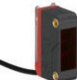
50145231 | LE5B/2       | 0 ... 12,5 m<br>0 ... 17,5 m          | Tensión de alimentación: CC<br>Salidas digitales: 1 Unidad(es)<br>Salida 1: Transistor, NPN, De conmutación claridad<br>(de conmutación oscuridad por inversión de polaridad de UB)<br>Frecuencia de conmutación: 900 Hz<br>Conexión: Cable, 2.000 mm, 3 hilos |
