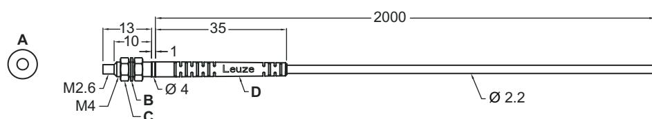
A Ø 1,0 mm núcleo de fibra sintética x 1 pc.
