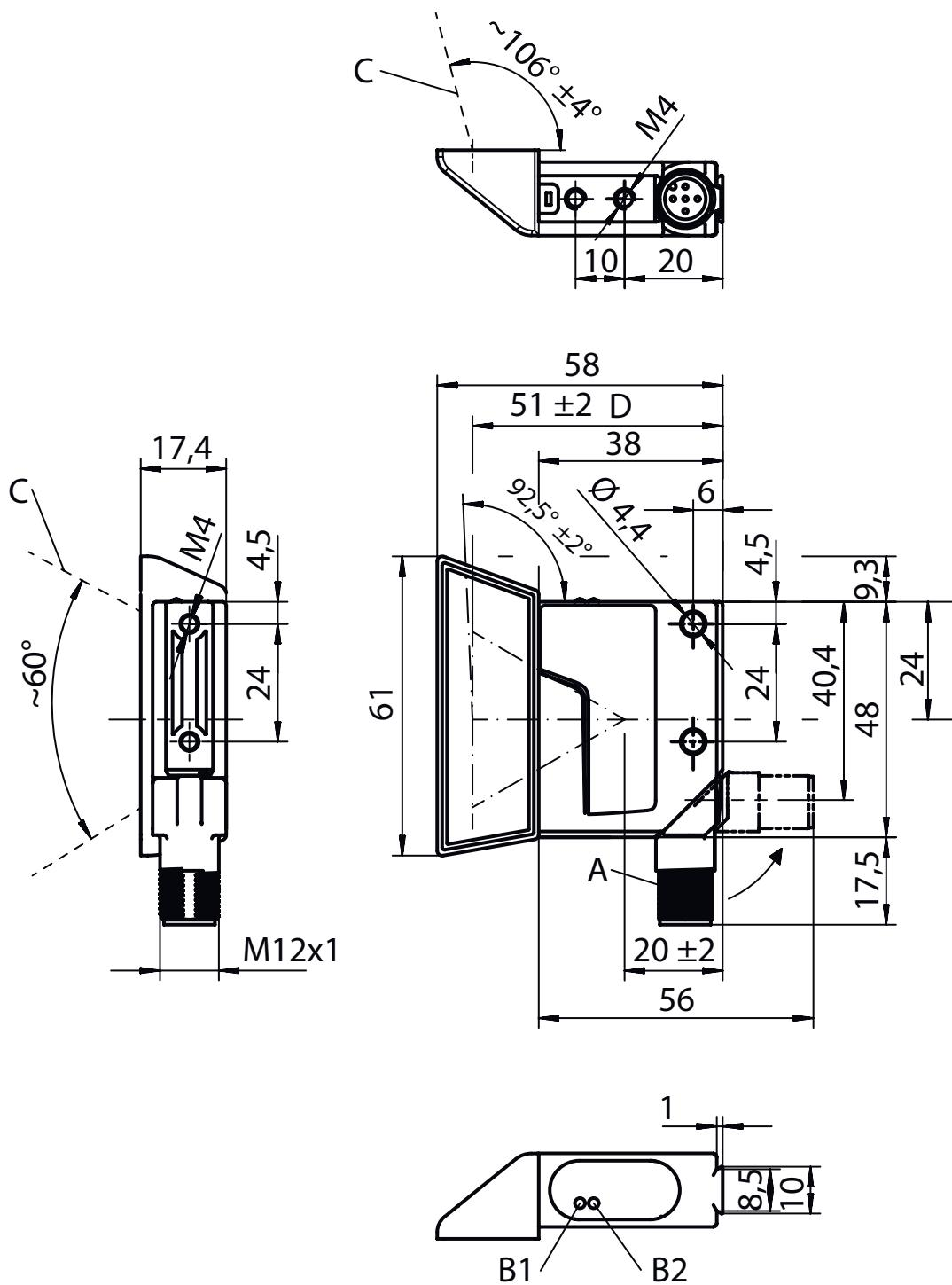
A Drehstecker, um 90° drehbar
