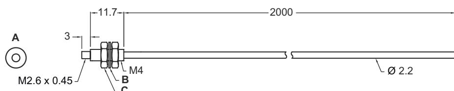
A Ø 1,0 mm núcleo de fibra sintética x 1 pc.
