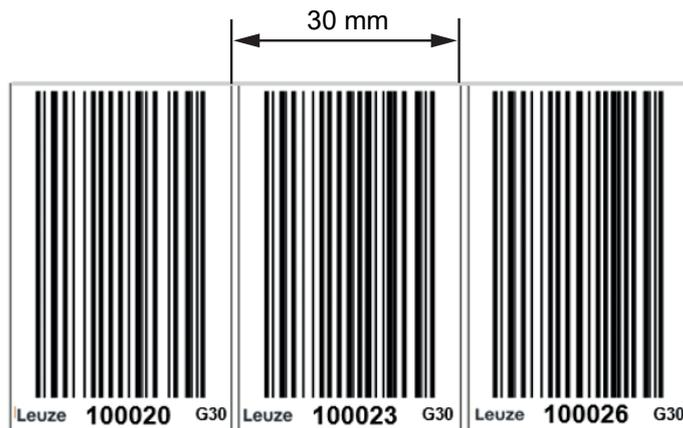
图 6.11: 示例：检查自行打印的在线维修用条码带上的 30 mm 尺寸
