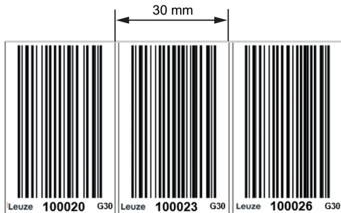
Fig. 6.11: Exemplo: verificar a dimensão de 30 mm na fita de códigos de barras de reparo online autoimpressa
