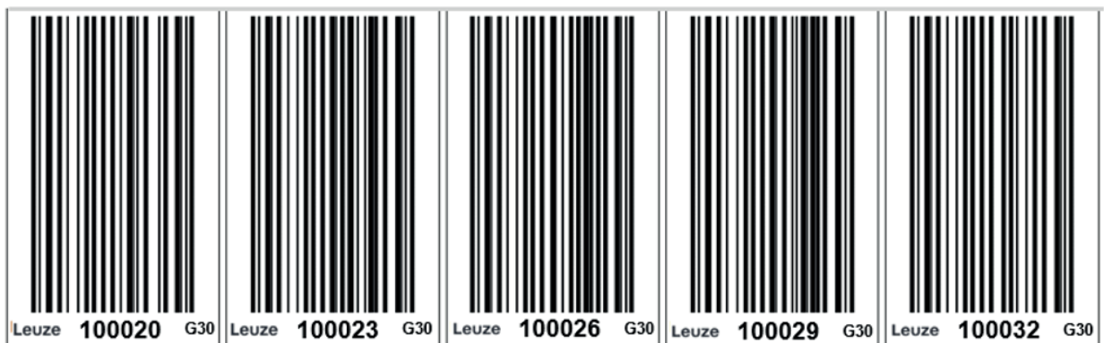
그림 4.2: 예시 바코드 테이프 BCB G30, 위치값 1000.20m에서 시작, 3cm씩 증가
