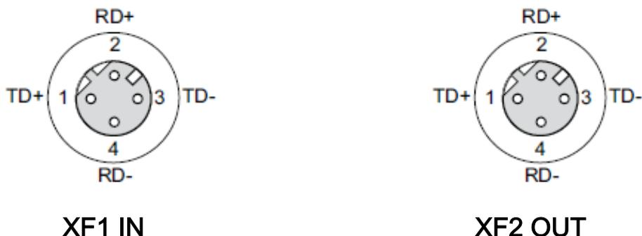
Figura 5.5: Connettori di piedinatura XF1 IN e XF2 OUT
