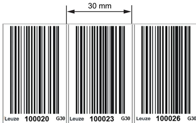
Figura 6.11: Esempio: verificare la misura di 30 mm sul nastro a codici a barre per la riparazione online auto-stampato
